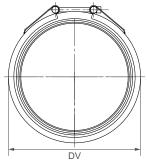
$\begin{array}{ccc} \text{DV} & \Leftrightarrow & \text{OD} + 38 \text{ mm} \\ \text{C} & \Leftrightarrow & 127 \text{ mm} \\ \text{R with strip insert} & \Leftrightarrow 60 \text{ mm} \\ \text{R without strip insert} \Leftrightarrow 15 \text{ mm} \\ \end{array}$
