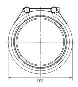
$\begin{array}{ccc} \text{DV} & \Leftrightarrow & \text{OD} + 27 \text{ mm} \\ \text{C} & \Leftrightarrow & 91 \text{ mm} \\ \text{R with strip insert} & \Leftrightarrow 35 \text{ mm} \\ \text{R without strip insert} & \Leftrightarrow 10 \text{ mm} \\ \end{array}$
