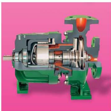
Pompa z korpusem spiralnym typu NML (EN 22858) z hermetycznym sprzęgłem magnetycznym.
