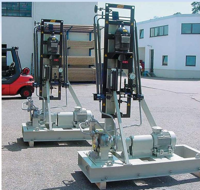
Typ NCR wg API 610 wyd.9 z podwójnym uszczelnieniem mechanicznym i systemem uszczelniającym Plan 53B + 31. Ciecz: węglowodory z wodą (zastosowanie w podziemnym wydobyciu).
