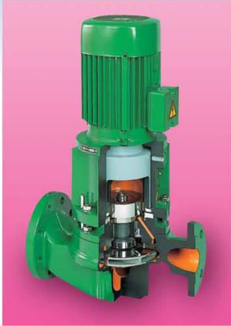
Pompa „in-line” z korpusem spiralnym typu KMV z hermetycznym sprzęgłem magnetycznym. Wydatek do 60 m 3 /h, wys. podnoszenia do 60 m.
