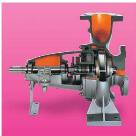
Pompa z korpusem spiralnym typu NKLs – z przeznaczeniem dla gorącego oleju z pojedynczym uszczelnieniem mechanicznym i pomocniczą dławnicą N10q.
