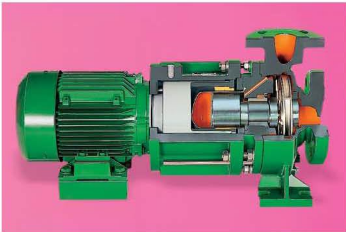
Pompa z korpusem spiralnym typu KMB z hermetycznym sprzęgłem magnetycznym. Wydatek do 60m 3 /h, wysokość podnoszenia 60 m .
