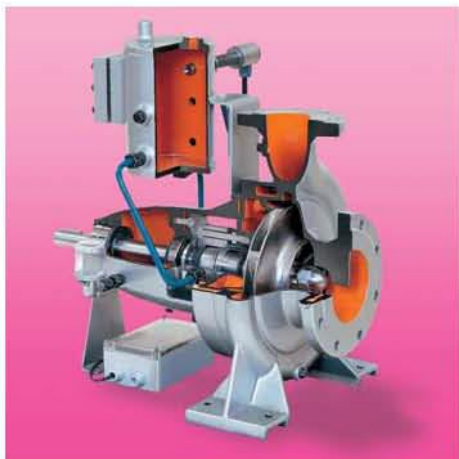
Pompa z korpusem spiralnym typu NCL (EN 22858) z uszczelnieniem mechanicznym Tandem N9.
