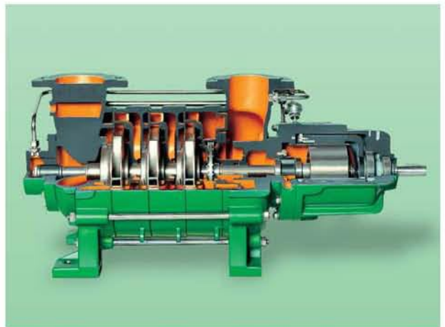
Pompa odśrodkowa samozasysająca typu HZSM z bocznokanałowym stopniem odpowietrzającym i hermetycznym sprzęgłem magnetycznym.
